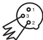
Un bouchon de terminaison réduit les erreurs de signal et évite les problèmes de transmission de signal et les interférences. Il est toujours recommandé de connecter un bouchon DMX (résistance 120 Ohm  $\frac{1}{4}$  W) entre la broche 2 (DMX-) et la broche 3 (DMX +) de la dernière unité.
